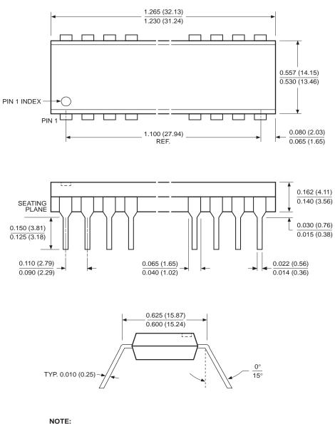
24-LEAD PLASTIC DUAL IN-LINE PACKAGE TYPE P
